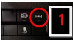
1 Differentialsperre Quer Hinterachse
